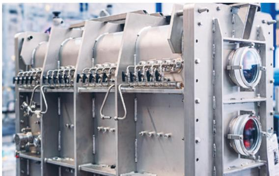
Das Herzstück der Sorptionsspeicher-Wärmepumpe SeasON (Bild Matica AG).
